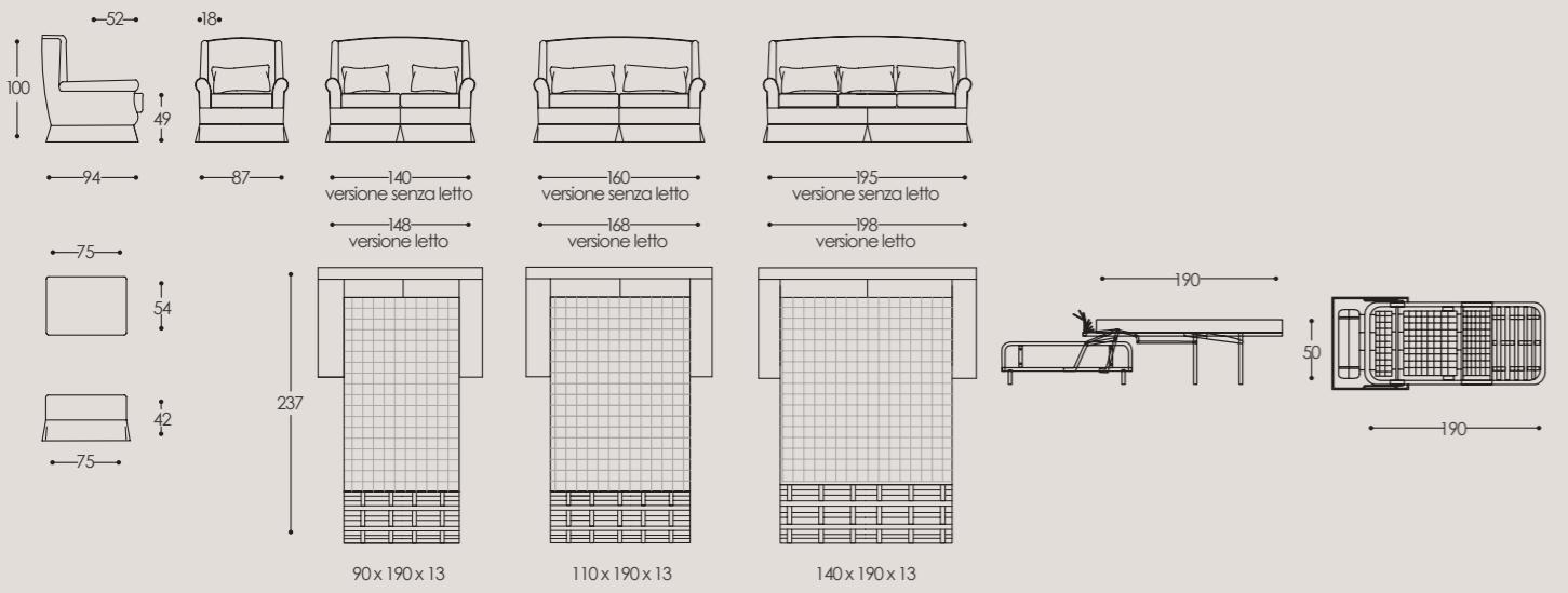
Варианты: пuf, кресло, диван 2-х, 2 ½, 3-х местные могут быть укомплектованы раскладным механизмом с металлической решеткой и полиуретановым матрасом 13 см. Структура: дерево и его производные, перекрещенные эластичные ремни высокой прочности. Набивка: по умолчанию полиуретан средней жесткости (гомма), полистероловые волокна. По запросу можно изменить тип наполнения подушек сидения (за дополнительную плату). Характеристики: съемный чехол; декоративная юбка; серийные декоративные подушки из пуха.
